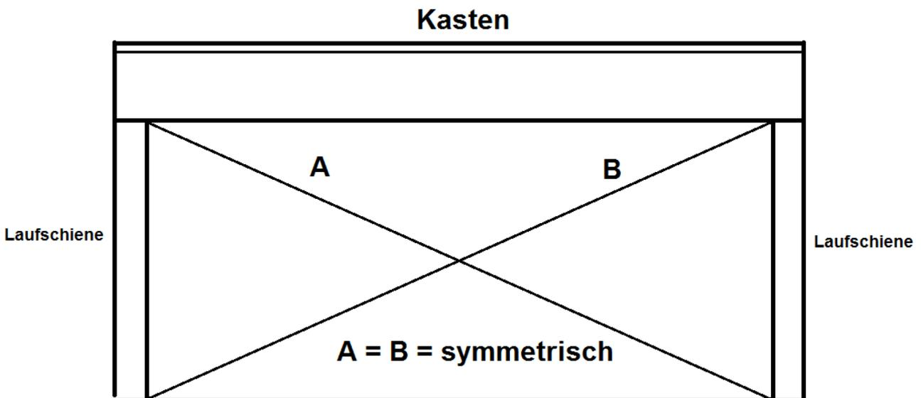
**Nach** erfolgter Verschraubung der Laufschienen und des Kastenseitenteiles am Montagehintergrund, öffnen Sie den Revisionsdeckel am Kasten und entnehmen die vorhandenen Transportdämmeinlagen (Pappe / Styropor). Lösen Sie dazu vorher beide Schrauben links und rechts an der Kastenunterseite. Nach vollständiger Entnahme des Dämmmaterials aus dem Kasten, lassen Sie das Rolltor ganz herunterfahren. Bitte achten Sie auf einen korrekten Stromanschluss.
